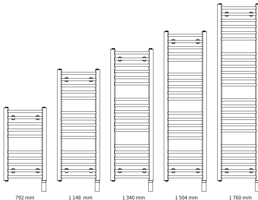
UKŁAD GRZEJNIKA PRZY WYSOKOŚCI: radiator shape and design with the height:
